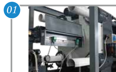
01 采用进口磁致尺对开合模过程进行精确控制
