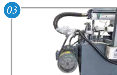
03 液压系统采用日本YUKEN液压设备,具备速度控制能力和低压合模保护功能
